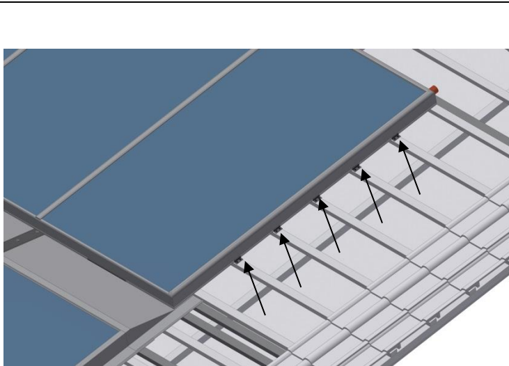
29. Montageklammern setzen und fixieren – oben rechts Fasten and fix clamps – right border
