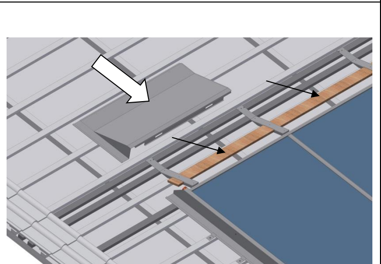
46. Firstbleche "Mitte" zusammenstecken u. fixieren Stick and fix ridge-boards "center" – on top
