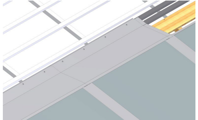
50. Kehldichtkeile anbringen – oben und seitlich Situate sealing-wedges on top and border
