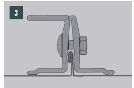
Die Verlegerichtung des Halters ist so zu wählen, dass die Gewindestange im Anschluss falzseitig angebracht werden kann.
