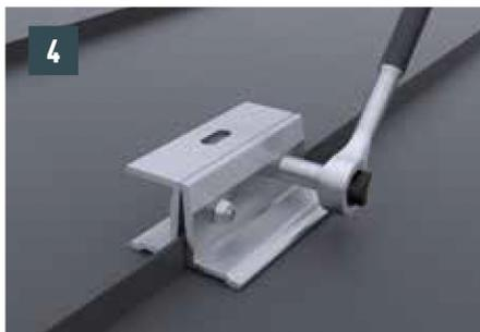
Die beiden Edelstahlmutter mit einem Drehmoment von 35 Nm festziehen.
